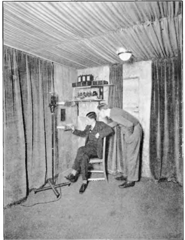
Om storingen van in de nabijheid opgestelde motoren te voorkomen, is de Baird studio geheel met bladkoper bekleed
