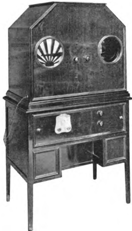
Een complete televisie ontvanger. Antenne, aarde en een stopcontact en geluid en televisie treden uwe woning binnen. (Fabrikaat Baird)
