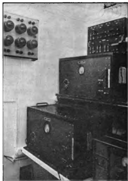
Een tweetal 50 Watt-versterkers in combinatie met een grammofoon-microfoonversterker vormen de muziekweergever van de Statendam
